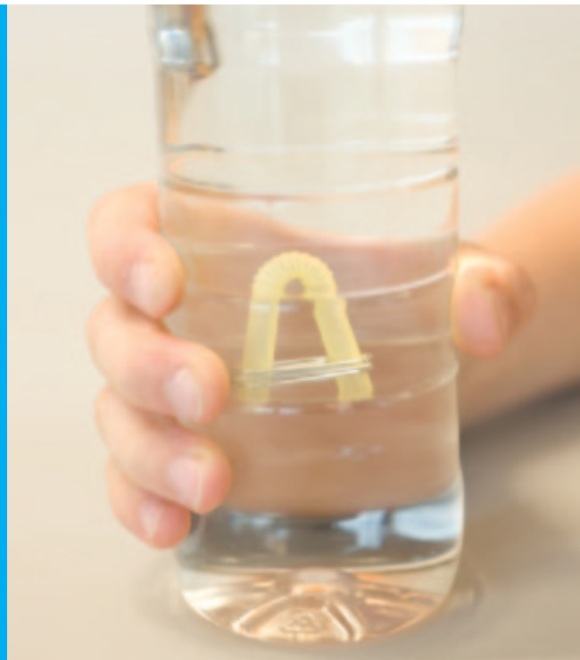
Abb. 5: Drückt man die Flasche zusammen, dann sinkt das Tauchermännchen.
